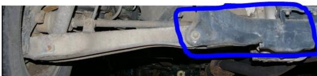
**Figura 27:** Base de fixação de uma bandeja (Suspensão automotiva, 2014)
