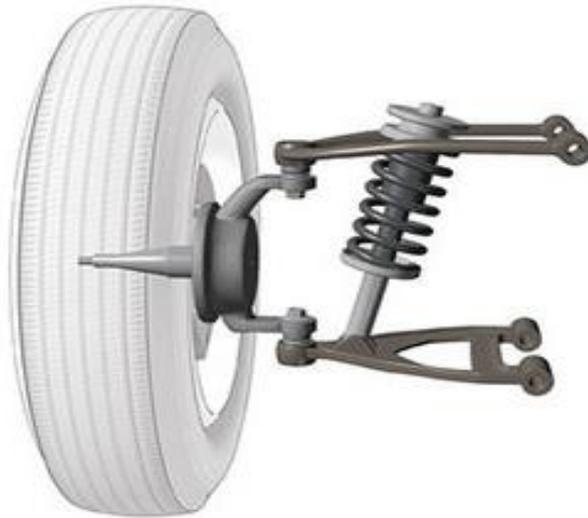
**Figura 3:** Sistema de suspensão do tipo duplo A (Quatro rodas, 2010)
