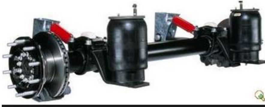
**Figura 6:** Suspensão pneumática (Cargo Bull 2009)
