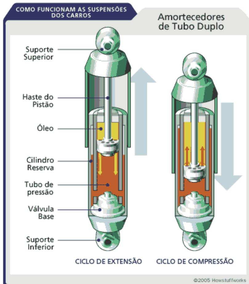
**Figura 13:** Ciclos do amortecedor (Carros uol, 2013)
