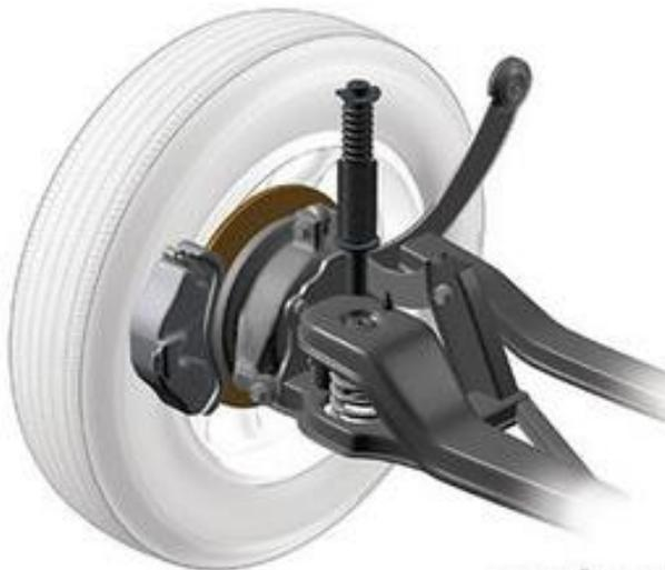
**Figura 4:** Sistema de suspensão Multilink (Quatro rodas, 2010)
