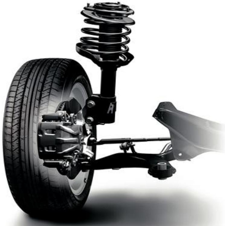
**Figura 2:** Sistema de suspensão Macpherson (Razão automóvel,2015)
