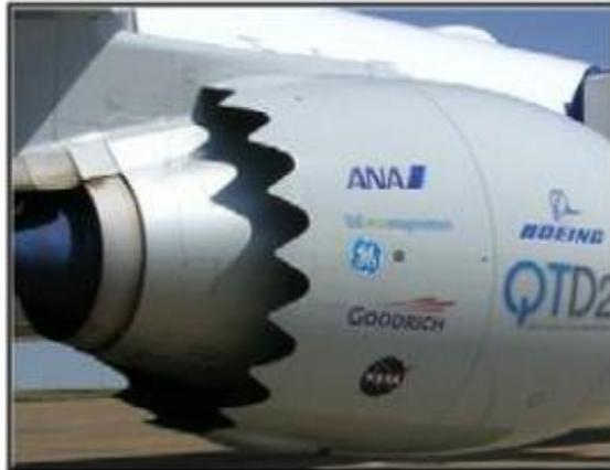
**Figura 24:** Atuadores para redução de ruídos de motores a jato (AGUIAR,2011)
